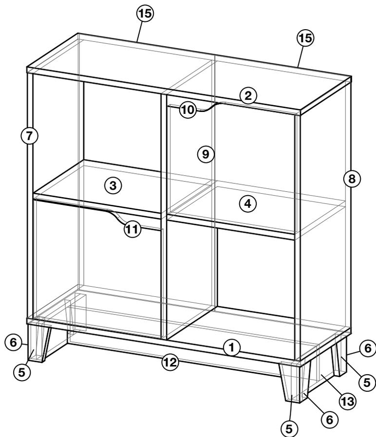
**1** Закрепите полку (4) к боковине правой (8) при помощи эксцентриковых стяжек, к перегородке (9) при помощи конфирматов (7x50)
