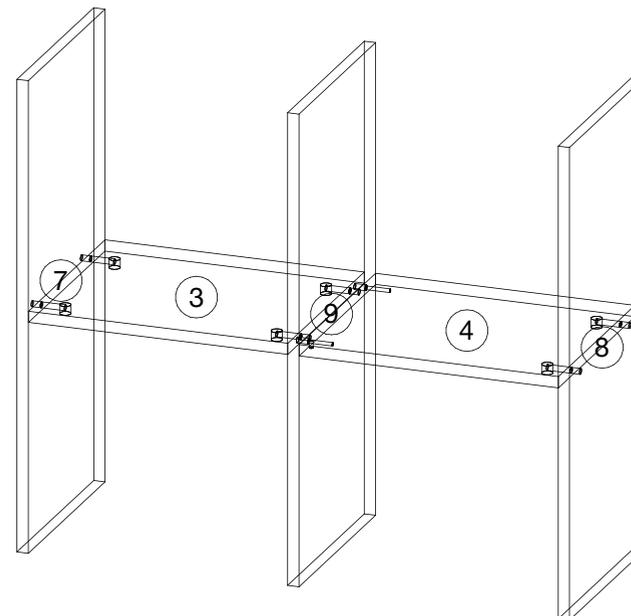
**3** Закрепите крышку (2) к боковине левой (7), боковине правой (8) и перегородке (9) при помощи эксцентриковых стяжек, дно (1) при помощи конфирматов (7x50), закрепите задние стенки (15) при помощи гвоздей, соблюдая правильную геометрию изделия (диагонали)
