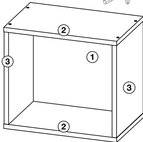
**1** Закрепите навесные планки к задней стенке (1) при помощи саморезов (3,5x16), установите в торцы шканты (8x30)
