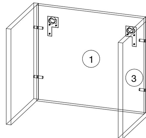
**3** Закрепите крышку (2) при помощи конфирматов (7x50) и шкантов (8x30)
