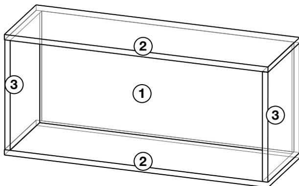
**3** Закрепите крышку (2) при помощи конфирматов (7x50) и шкантов (8x30)
