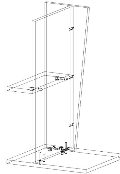
**3** Закрепите стойку (3) к полке (4) и дну (6) при помощи эксцентриковых стяжек, к стойке (2) при помощи шкантов (8x30)
