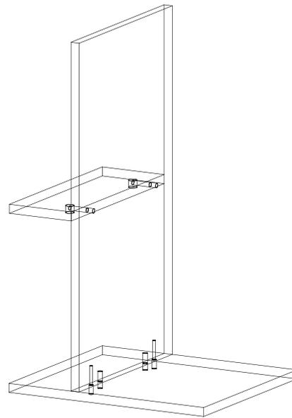
**2** Закрепите стойку (2) к дну (6) при помощи эксцентриковых стяжек и шканта (8x30), к стойке (1) при помощи шкантов (8x30)
