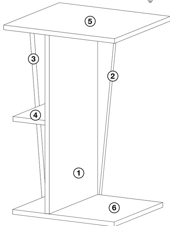
**1** Закрепите полку (4) на стойке (1) при помощи эксцентриковых стяжек, закрепите стойку (1) к дну (6) при помощи шкантов (8x30) и евроинтов (7x50)
