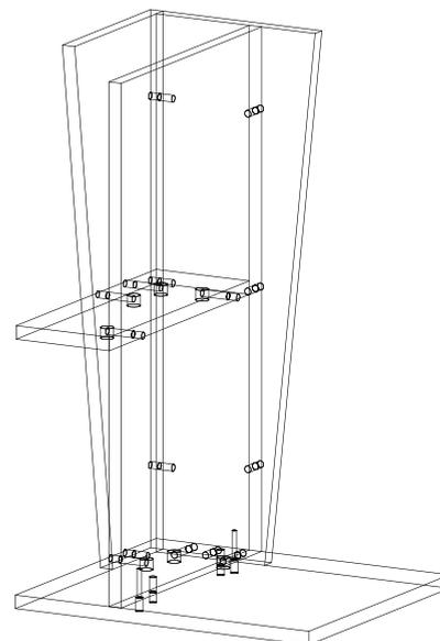
**4** Закрепите крышку (5) к стойкам (1, 2 и 3) при помощи эксцентриковых стяжек и шкантов (8x30)
