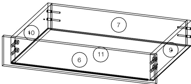
**6** Установите ящик в стол при помощи направляющих и саморезов (3.5x16), места креплений предусмотрены на боках ящиков (9 и 10), а так же на правой опоре (4) и перегородке (8)
