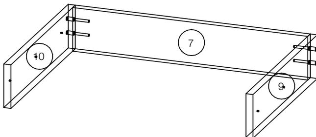
**5** Закрепите фасад ящика (6) к бокам ящика (9 и 10) при помощи эксцентриковых стяжек, закрепите дно ящика (11) при помощи гвоздей, соблюдая правильную геометрию изделия (диагонали)
