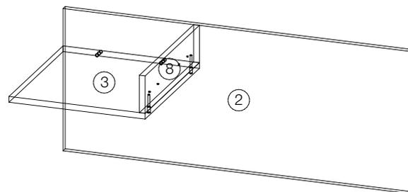
**2** Закрепите опору левую (5) к распорке (2) и полке (3) при помощи эксцентриковых стяжек, закрепите опору правую (4) к распорке (2) при помощи эксцентриковых стяжек
