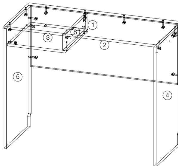
**3** Закрепите крышку (1) к опоре левой (5), распорке (2), перегородке (8) и опоре правой (4) при помощи эксцентриковых стяжек
